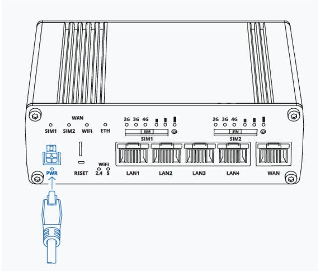
Sollte auf dem Bordnetz keine dauerhafte Stromversorgung sein, schalten Sie bitte die Zündung Ihres Fahrzeugs ein. Der Router startet nun, was Sie je nach Montage des Routers auch am Aufleuchten der Dioden erkennen können.
