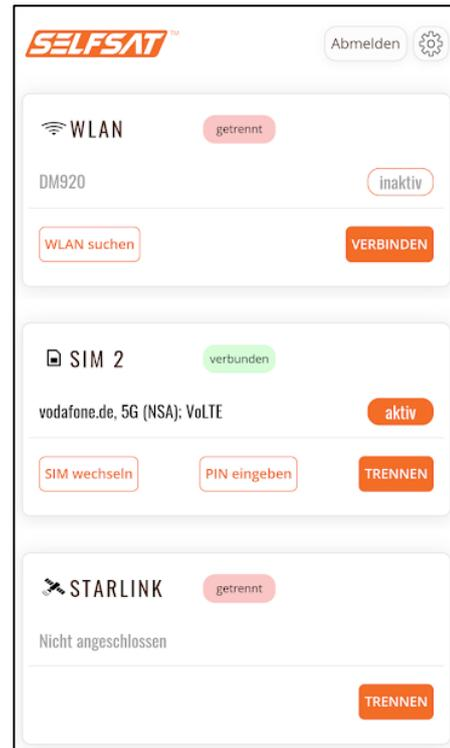
Sollten Sie die 2. SIM-Karte bereits vor dem Anbindung des Routers an den Strom eingelegt haben, drücken Sie nun auf „**SIM wechseln**“ im „**SIM**“ Feld. Die Anzeige wechselt auf „**Wechsle SIM Schacht**“. Anschließend erscheint „**SIM 2**“ im „**SIM**“ Feld.
