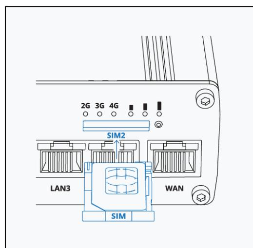
Wenn Sie die SIM-Karte bereits vor der Anbindung des Routers an den Strom eingelegt hatten, ist es nun nötig, die PIN der SIM-Karte das erste Mal einzugeben.
