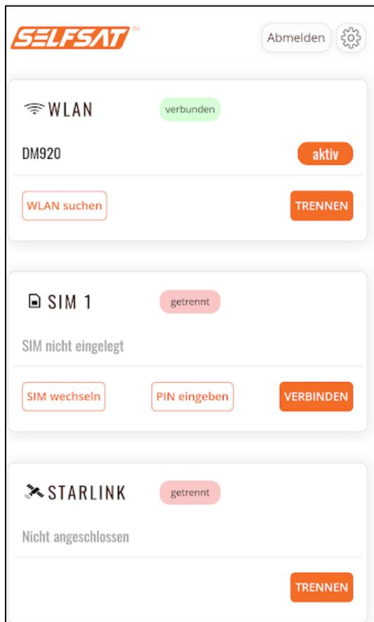
**Sollten Sie eine Verbindung mit einem externen WLAN erhalten, aber keine Internetverbindung möglich sein, kann dies daran liegen, dass die WLAN-Gegenstelle die gleiche IP-Adresse (10.10.10.10) wie Ihr SELFSAT Router hat. Ändern Sie in diesem Fall die IP-Adresse Ihres Routers im entsprechenden Menü auf 192.168.1.1 (Achtung: Nach Änderung erreichen Sie die Benutzeroberfläche unter 192.168.1.1).**
