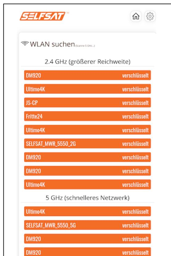
Anschließend werden die verfügbaren WLAN-Netze angezeigt. Wählen Sie das gewünschte WLAN-Netz aus, geben Sie dessen Passwort ein und drücken Sie auf die „**Weiter**“-Taste. Wenn kein Passwort benötigt wird drücken Sie ebenso die „**Weiter**“-Taste.
