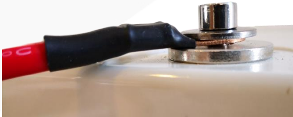
Abbildung 3. FEHLER! Lose Verbindung durch Verwendung einer zu langen Schraube
